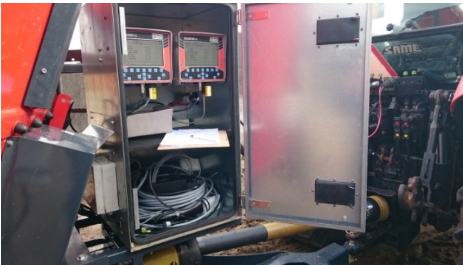
Foto 3. Tekniskab monteret på forsøgsblander.
