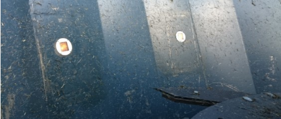
Foto 2. To NIR sensorer monteret i forenden af VM-22 foderblander.
